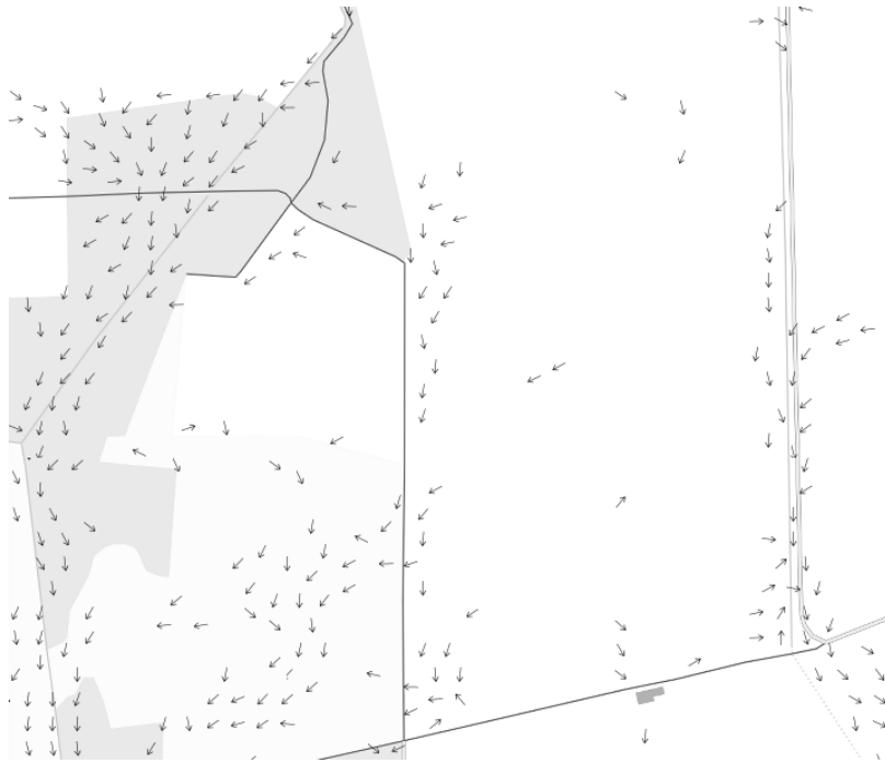
Ausschnitt aus der NIBIS Hinweiskarte 'Starkregengefahren' hier Fließrichtung extremes Ereignis für Niedersachsen Westerholz ohne Maßstab
